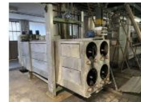
Referencia: STV-006 LAVADERO DE 4 RASCLES Año: . Marca: Cominox Ancho mesa: 3200mm WW
