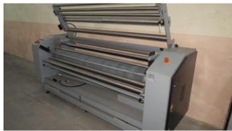
Referencia: QTX-008 DESENROLLADOR DE TEJIDOS Año: 2005 Marca: STI SERVIZI TECNICI INTEGRATI Ancho mesa: 1940
