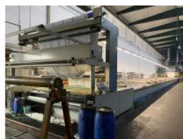
Referencia: STV-002 ESTAMPADORA PLANA 9 colores 32... Año: 1995 Marca: Reggiani Ancho mesa: 3200mm WW
