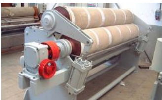
Referencia: CC0015 Foulard de escurrido y aprestado Año: 1983 Marca: Benguerel Ancho mesa: 2400
