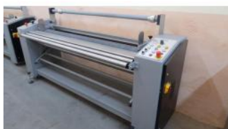
Referencia: QTX-006 ENROLLADORA DE TEJIDOS Año: 2005 Marca: STI SERVIZI TECNICI INTEGRATI Ancho mesa: 1940
