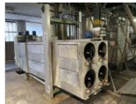
Referencia: STV-006 LAVADERO DE 4 RASCLES Año: . Marca: Cominox Ancho mesa: 3200mm WW
