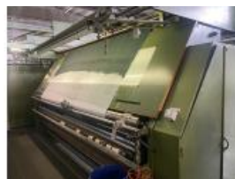
Referencia: STV-013 REVISADORA ENROLLADORA 3200mm Año: 1989 Marca: LAZZATI FRANCO Ancho mesa: 3200mm
