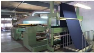
Referencia: TTM-013 COMPACTADORA CON RAMETA Año: 1994 Marca: Sperotto Ancho mesa: 2400
