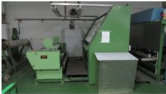
Referencia: MTB-027 Revisadora Enrolladora Año: 1989 Marca: Tapalsa Ancho mesa: 1800
