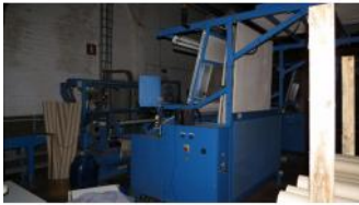
Referencia: MIC-038 Revisadora Enrolladora Año: 1997 Marca: MATTHYS Ancho mesa: 2000
