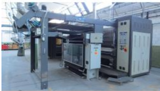
Referencia: FNX-019 DECATIZADORA DISCONTINUA Año: 1993 Marca: Mario Crosta Ancho mesa: 1950
