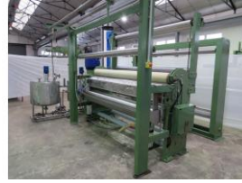
Referencia: CR-137 Foulard de impregnación Año: 1980 Marca: Kusters Ancho mesa: 2400
