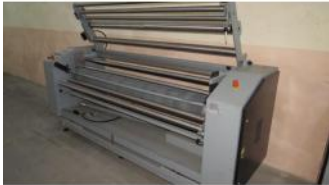
Reference: QTX-008 UNROLLING MACHINE Year: 2005 Brand: STI SERVIZI TECNICI INTEGRATI Width: 1940
